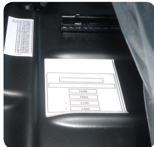
Tillverkarens märkning sitter i hytten, under passagerarsätet.
